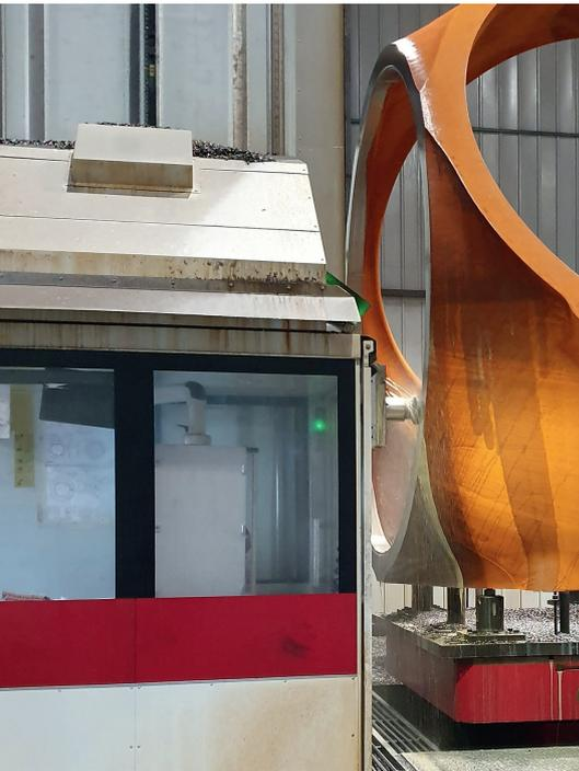
2 Die betreffende Windkraftanlagen-Nabe besteht aus GGG40, ist 6 m hoch, 42 t schwer und hat eine Wandstärke von 200 bis 250 mm. Bei einer Losgröße von 150 Stück ist das Fräs-werkzeug LN90 knapp 21 km im Jahr »unterwegs«
