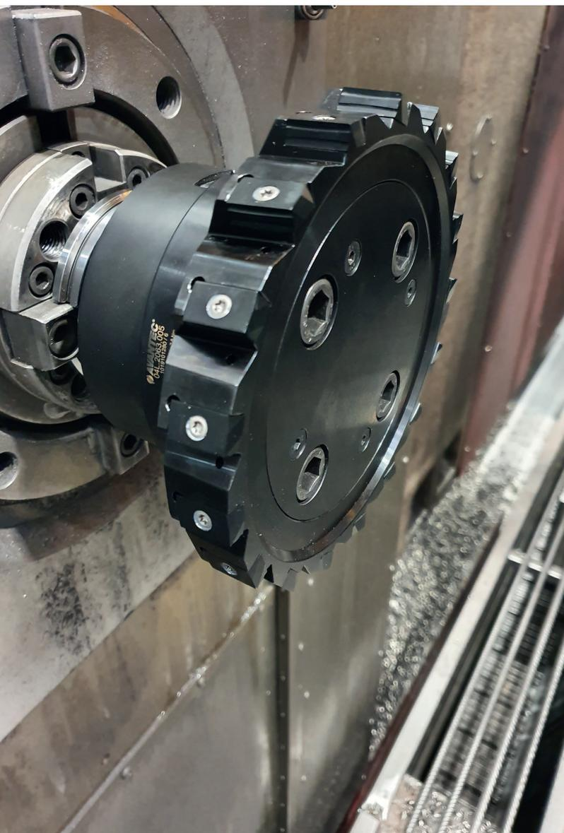
1 Dieser Eckfräser LN90 von Avantec fräst die Flanschflächen von Rotornaben doppelt so tief wie sein Vorgänger und verdoppelte damit das Zeitspanvolumen  $Q$  gegenüber dem bisherigen Prozess. Zudem stieg die Standmenge von 1 auf 2 Naben. Das Endergebnis: Die Stückkosten sanken um 43 Prozent © Avantec
